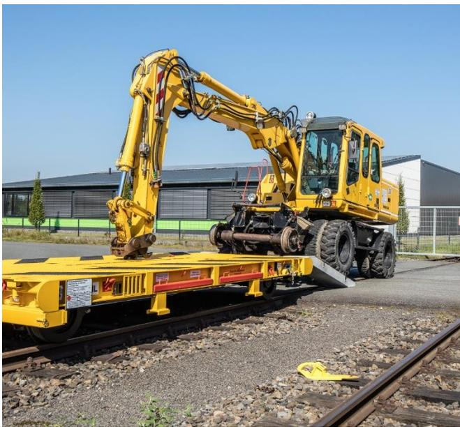
Der Gleisbauanhänger T5025 ist mit einem Zweiwege-Bagger ein- und aussetzbar sowie mit einem Standard-LKW zu transportieren.
