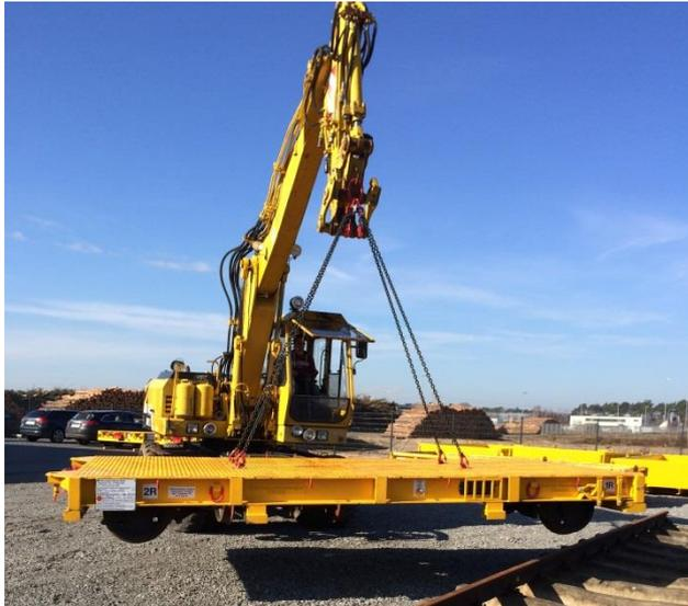
Der Gleisbauanhänger T5020 ist mit einem Zweiwege-Bagger ein- und aussetzbar sowie mit einem Standard-LKW zu transportieren.
